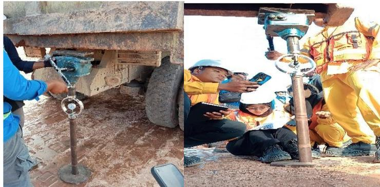
Gambar 3. 31 Pengujian CBR Lapangan
