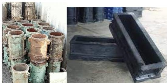
Gambar 3. 24 Cetakan beton silinder dan balok
