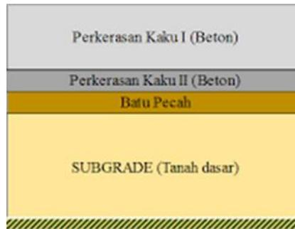
Gambar 3. 29 Susunan Struktur Perkerasan Kaku
