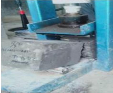
Gambar 3. 44 Pengujian kuat lentur beton
