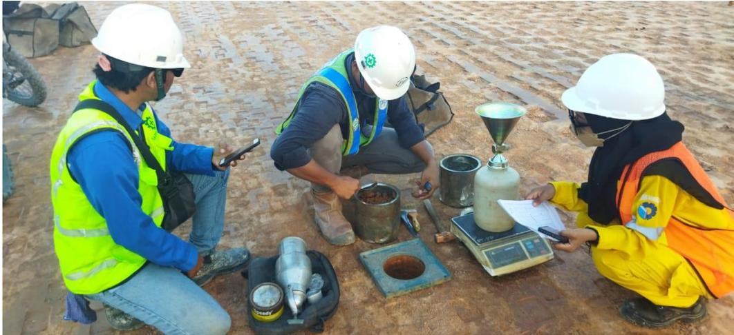
Gambar 3. 30 Pengujian Sandcone
