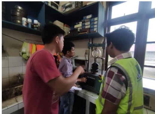
Gambar 4. 9 Pengujian Marshall test
