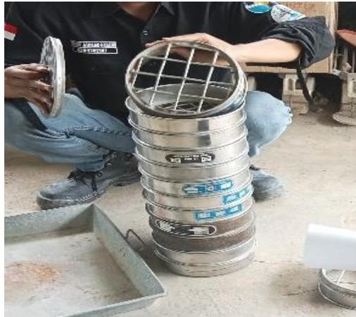
Gambar 3. 18 Saringan uji gradasi
