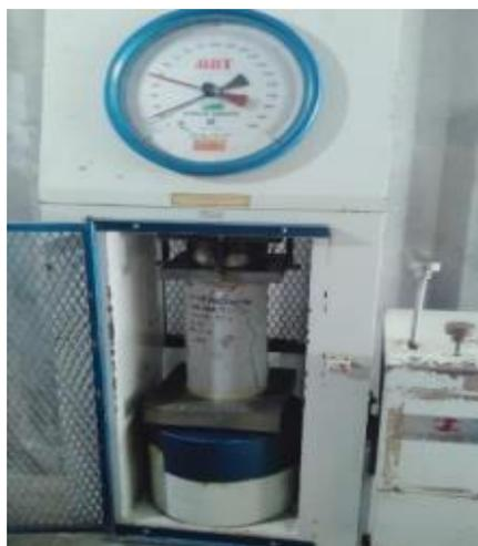
Gambar 3. 43 Pengujian kuat tekan beton
