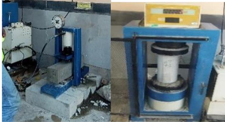
Gambar 3. 27 Alat uji kuat tekan silinder dan kuat lentur balok
