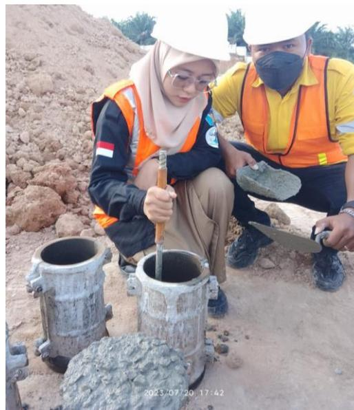
Gambar 3. 37 Pembuatan sampel benda uji beton
