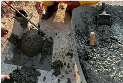
Gambar 3. 36 Pembuatan benda uji slump
