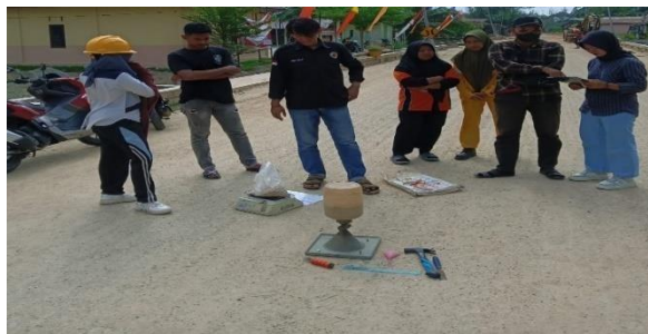
Gambar 3. 14 Pengujian sand cone test Sumber : Dokumentasi Lapangan, 2023
