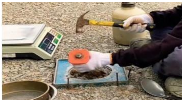
Gambar 3. 28 Pengujian Sand Cone Base A Sumber : Dokumentasi Lapangan, 2023
