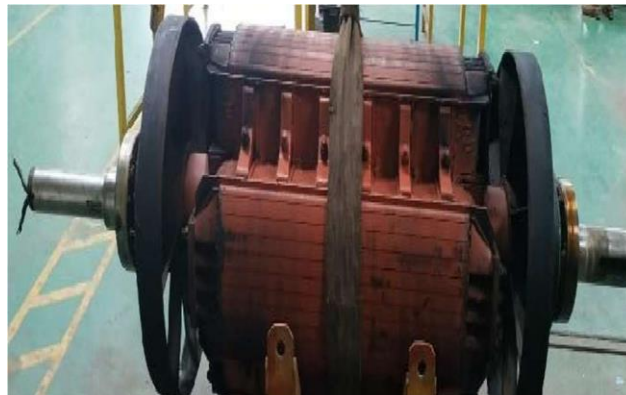
Gambar 4. 5 Kondisi Main Rotor sebelum dibersihkan (Sumber: Laporan Report Incoming Inspection PT. IndoTurbine)
