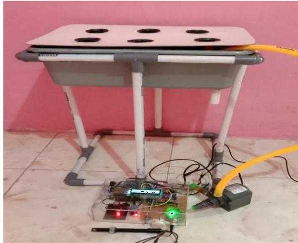
**Gambar 2. 1** Pengontrol pH Air Untuk Tanaman Hidroponik
