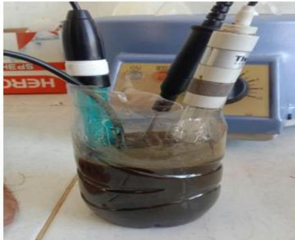
**Gambar 2. 2** Pengujian Sensor pH pada POME
