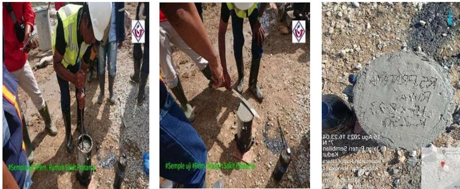
Gambar 3. 12 Pembuatan sampel pengujian
