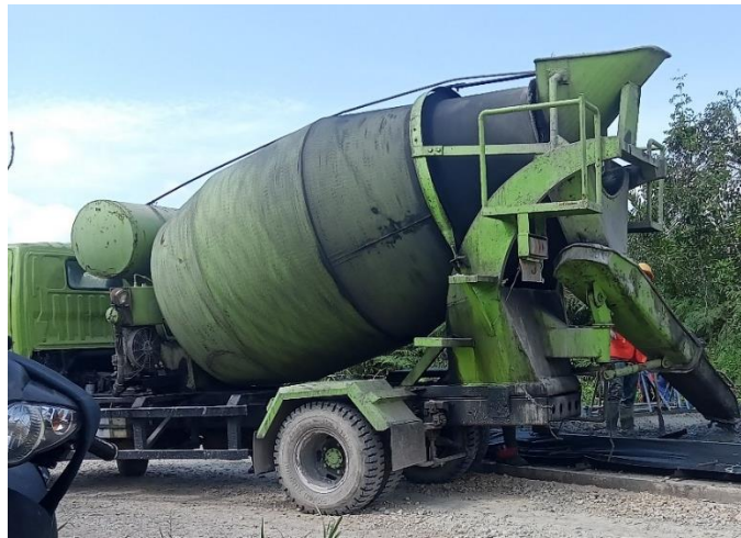
Gambar 4.1 Truck Mixer (sumber: Dokumentasi Lapangan 2023)
