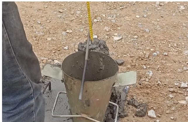
Gambar 4.17 Pengukuran Slump Test (Sumber: Dokumentasi Lapangan 2023)
