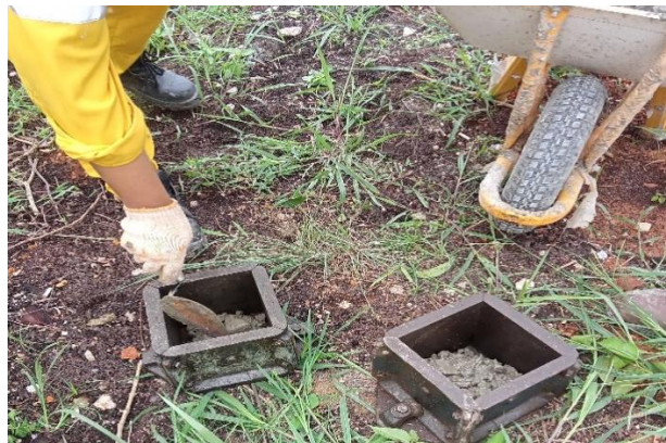
Gambar 4.19 Memasukan Sampel beton Kubus kedalam cetakan (Sumber: Dokumentasi Lapangan 2023)
