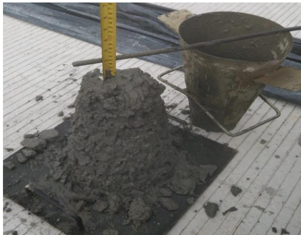
Gambar 3.29 Pengujian Slump Test Sumber: Dokumentasi Lapangan 2023
