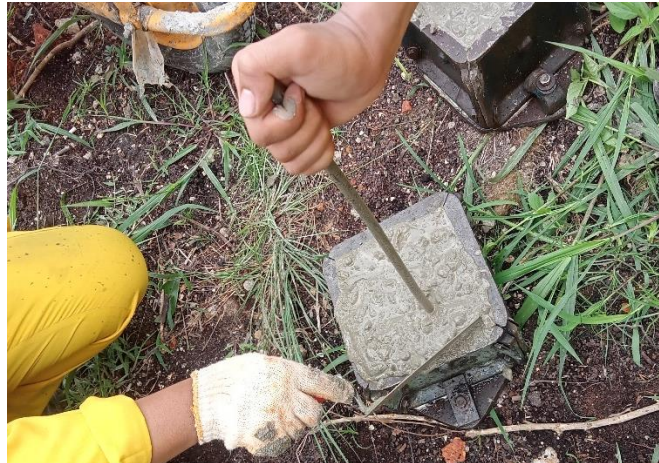
Gambar 4.20 Penusukan Sampel beton Kubus (Sumber: Dokumentasi Lapangan 2023)
