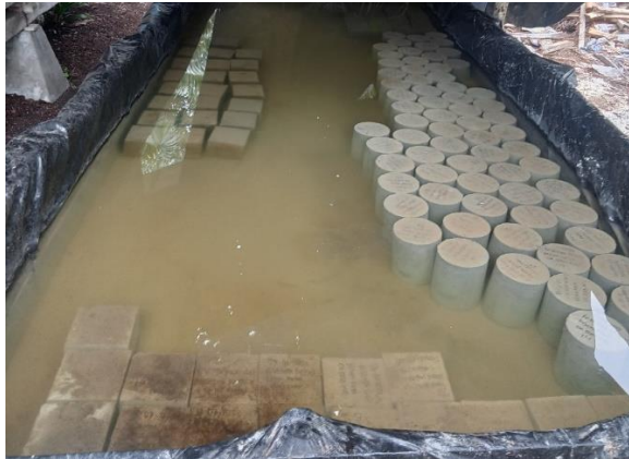
Gambar 3.36 Sampel Untuk Pengujian Kuat Tekan Beton Sumber: Dokumentasi Lapangan 2023
