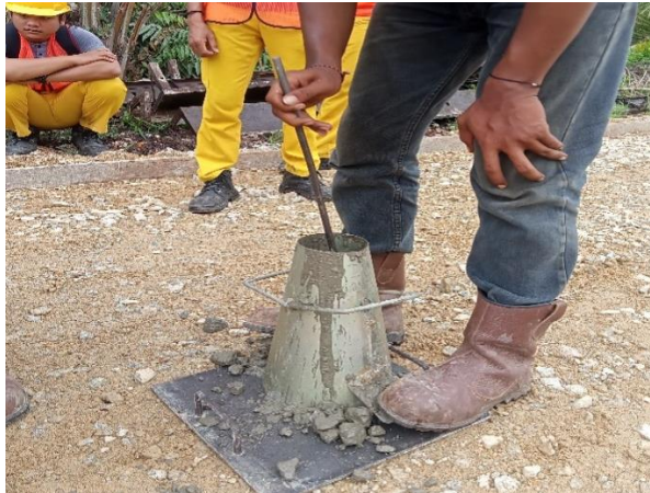
Gambar 4.14 Penusukan sampel uji (Sumber: Dokumentasi Lapangan 2023)
