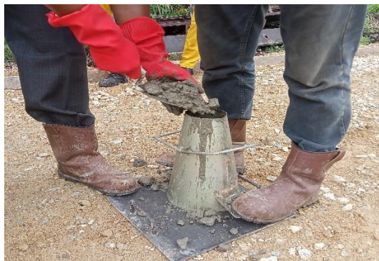
Gambar 4.13 Memasukan sampel uji kedalam cetakan (Sumber: Dokumentasi Lapangan 2023)
