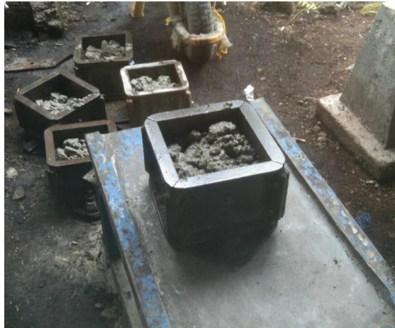
Gambar 3.30 Pembuatan Sampel Kubus Bahu Jalan Sumber: Dokumentasi Lapangan 2023
