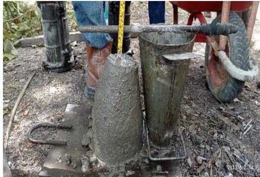
Gambar 3.33 Pengujian Slump Sumber: Dokumentasi Lapangan, 2023
