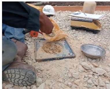
Gambar 3. 16 Dokumentasi Uji Sand Cone (Sumber: Dokumentasi KP penulis,2023)
