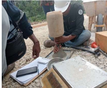
Gambar 4. 8 Proses Uji Sand Cone (Sumber: Dokumentasi KP penulis, 2023)
