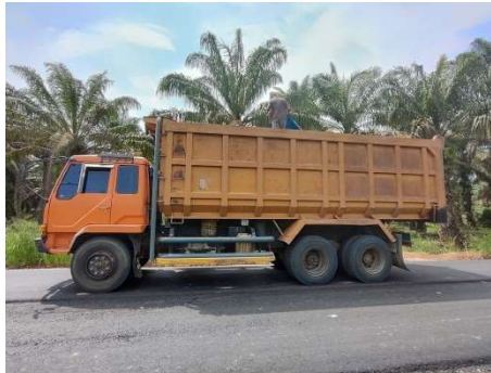
Gambar 3.2.18. Mobilisasi Laston Lapis Aus (AC-WC) (Sumber: Dokumentasi Lapangan Kerja Praktek 2023)
