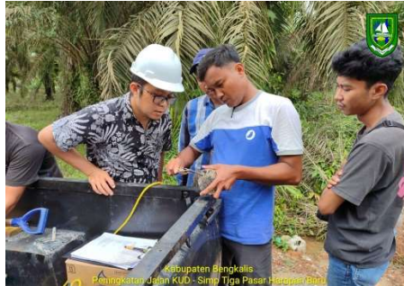
Gambar 3.1.25. Pengukuran Sampel Laston Lapis Aus (AC-WC) (Sumber: Dokumentasi Lapangan Kerja Praktek 2023)
