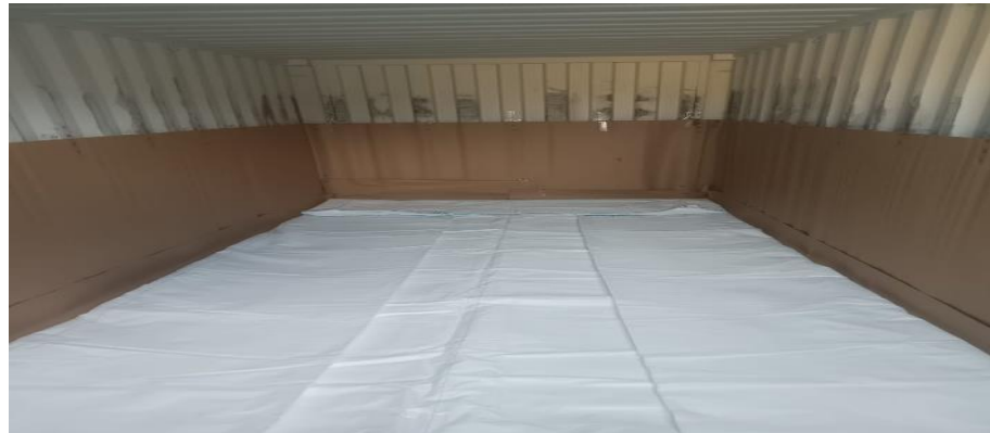
Gambar 4.4 Setelah Pemasangan Flexibag
