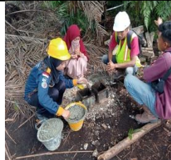
Proses memasukkan campuran beton kedalam cetakan kubus
