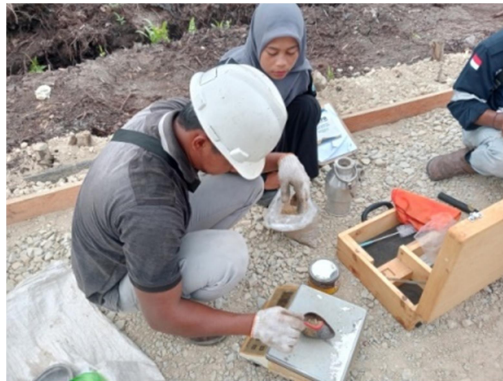
Gambar 3. 18 Pengujian Sandcone (Sumber: Dokumentasi KP Penulis, 2023)
