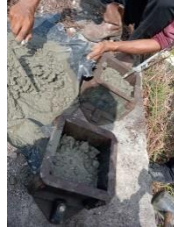
Proses memasukkan sampel ke dalam cetakan kubus
