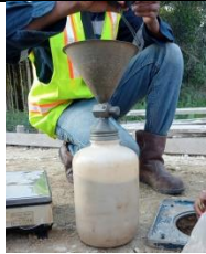
Tabung kerucut berisi pasir otawa
