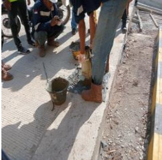
Proses Pengujian Uji slump
