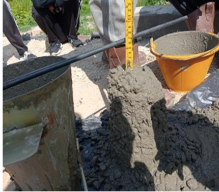
Gambar 4. 12 Proses Cek Kekentalan (Sumber: Dokumentasi KP Penulis, 2023)
