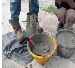
Proses memasukkan campuran beton kedalam kerucut abrams menggunakan sendok semen
