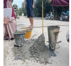
Proses pengukuran tinggi campuran beton dengan tinggi kerucut pada pengujian uji slump
