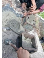
Proses memadatkan sampel menggunakan palu karet
