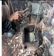
Proses tusuk dan memukul dengan alat tongkat pemadat dan palu karet
