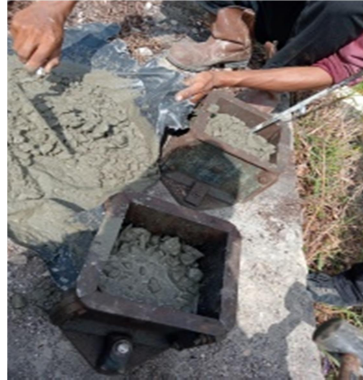
Gambar 4. 13 Pembuatan Sampel Kubus (Sumber: Dokumentasi KP, 2023)
