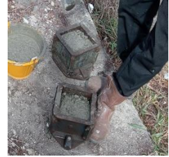
Kondisi cetakan kubus yang sudah terisi beton
