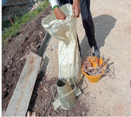
Gambar 4. 10 Persiapan Alat Uji Slump (Sumber: Dokumentasi KP Penulis, 2023)
