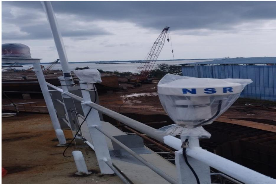
Gambar 3. 2 Pemasangan Antena AIS
