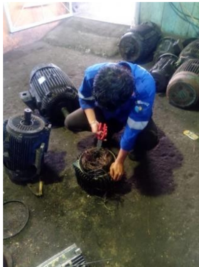
Gambar 2. 59 melepaskan tembaga dari elmot crane
