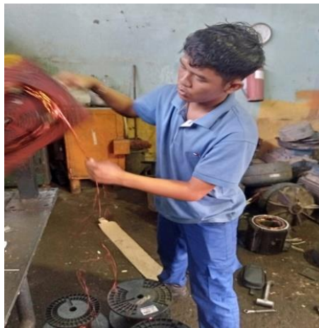
Gambar 2. 25 menggulung lilitan untuk motor
