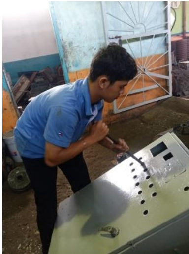
Gambar 2. 15 membuat lubang panel untuk memasukkan push button
