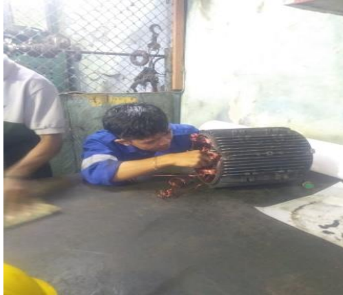
Gambar 2. 17 memasang tembaga ke motor confeyor distribusi 7,5 Kw
