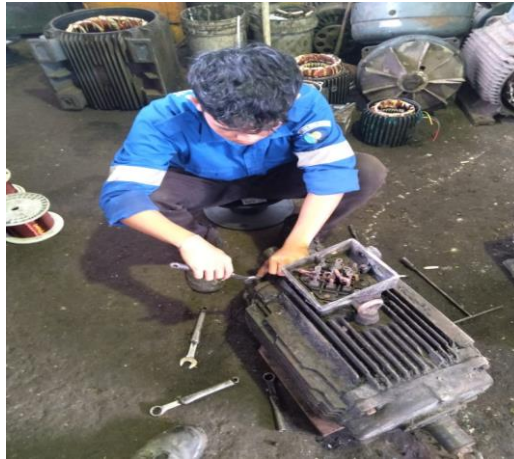
Gambar 2. 20 membongkar motor blower
