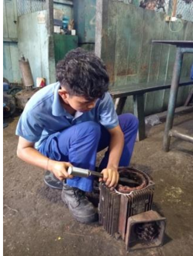
Gambar 2. 37 Melepaskan tembaga pada motor
