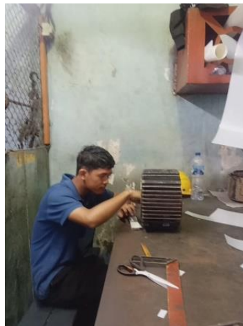
Gambar 2. 5 memasukkan pelapis dan penutup ke motor
