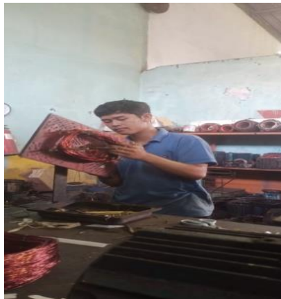
Gambar 2. 12 menggulung tembaga untuk di elmot
