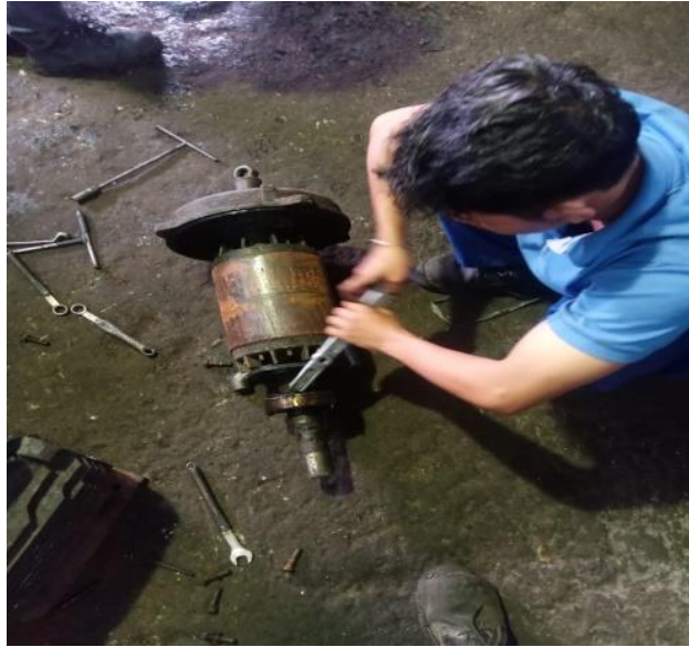
Gambar 2. 28 melepaskan bering pada rotor
