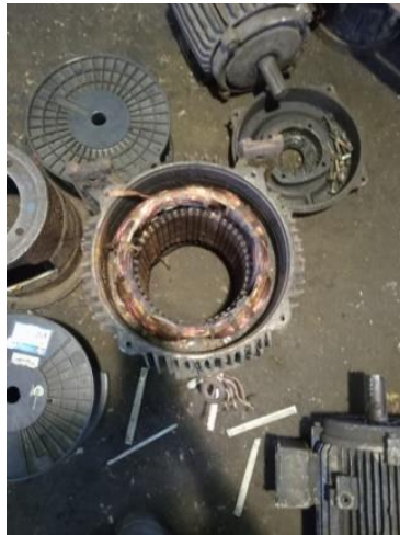
Gambar 2. 38 Pembongkaran tembaga pada motor
