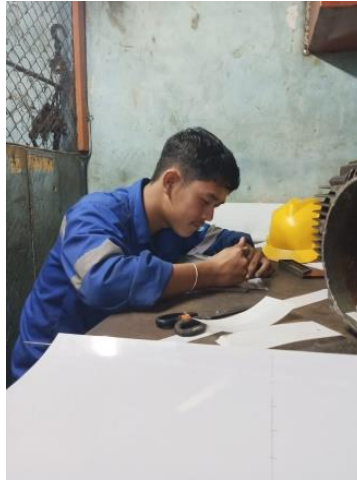
Gambar 2. 4 membuat pelapis dan penutup menggunakan litriod untuk motor agar tembaga yang di masukkan ke motor tidak terkena body motor
