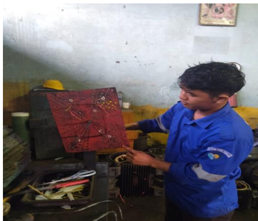
Gambar 2. 21 membikin lilitan untuk motor ripple mill
