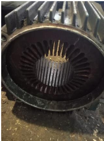
Gambar 2. 47 Membersihkan motor dari litroid bekas tembaga yang terbakar
