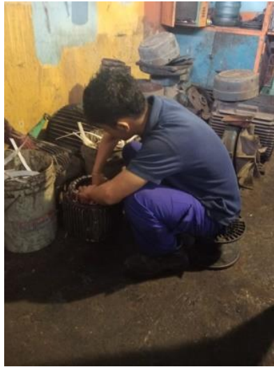
Gambar 2. 41 Melepaskan tembaga pada motor
