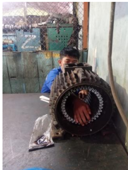
Gambar 2. 34 memasukkan pelapis pada elmot
