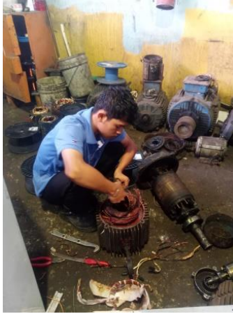
Gambar 2. 19 melepaskan tembaga dari motor
