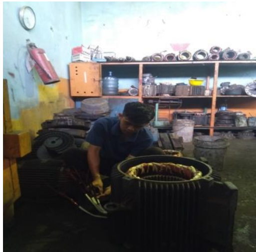
Gambar 2. 53 Mengupas tembaga supaya bisa menghasilkan arus untuk di sambungkan ke star delta
