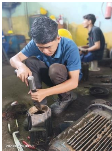
Gambar 2. 16 pembersihan tembaga pada motor
