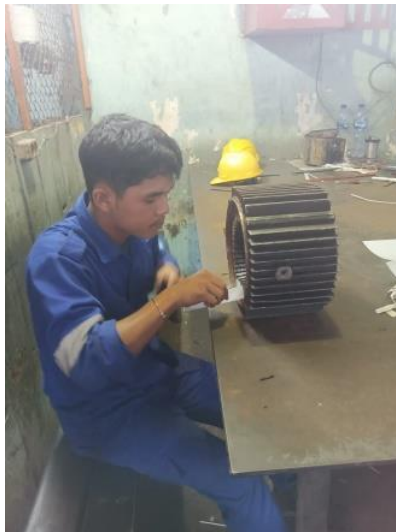
Gambar 2. 9 memasukkan pelapis dan penutup motor
