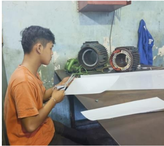
Gambar 2. 43 Membikin penutup untuk elmot
