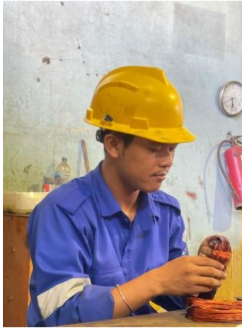
Gambar 2. 8 menggulung lilitan tembaga untuk dimasukkan ke motor
