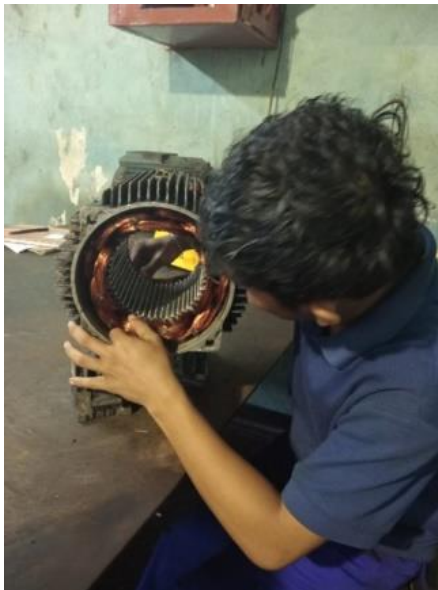
Gambar 2. 40 Memasukkan tembaga pada motor
