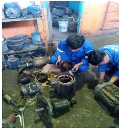
Gambar 2. 2 Pemasangan rotor untuk motorn 3 phasa 7,5 Kw
