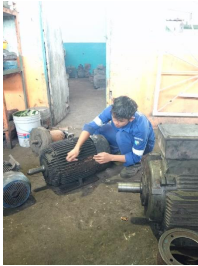
Gambar 2. 45 Membersihkan elmot dari serabut yang mengotori elmot
