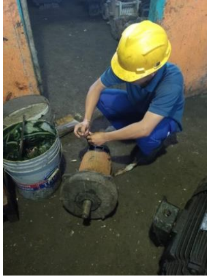
Gambar 2. 39 Melepaskan bering pada rotor
