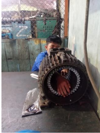
Gambar 2. 32 memasukkan pelapis pada elmot
