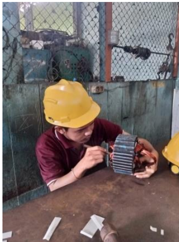
Gambar 2. 7 memasukkan tembaga ke motor
