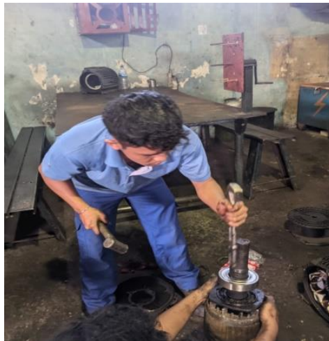
Gambar 2. 29 memasang bering pada rotor
