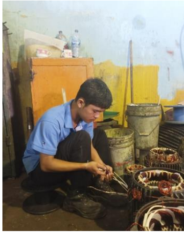
Gambar 2. 10 membersihkan tembaga untuk menghasilkan arus saat di sambungkan ke kabel star delta
