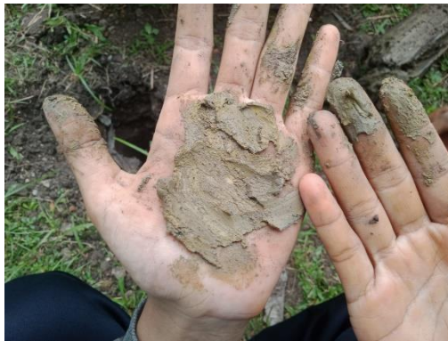
Gambar 3.5 Mengidentifikasi jenis tanah
