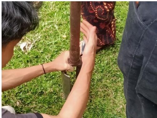
Gambar 3.18 Menyambungkan Mata Bor Dengan Stang Bor
