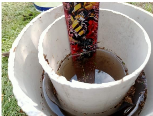
Gambar 3.11 Mengisi air kedalam pipa sampai 20 cm
