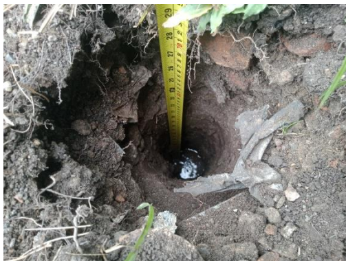
Gambar 3.6 Kedalaman air setelah mencapai MAT
