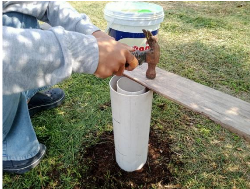
Gambar 3.9 Proses pengetukan pipa sedalam 10 cm
