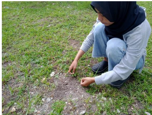
Gambar 3.8 Pembersihan lokasi pengujian infiltrasi
