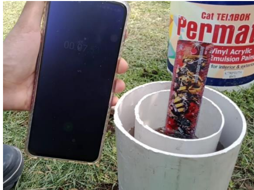
Gambar 3.12 Mencatat penurunan air setiap 2 menit menggunakan stopwatch
