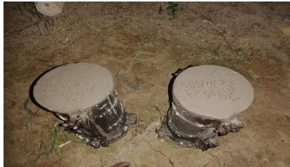
Gambar 3.6 Pembuatan sampel fc 10 MPA Sumber : dokumentasi lapangan
