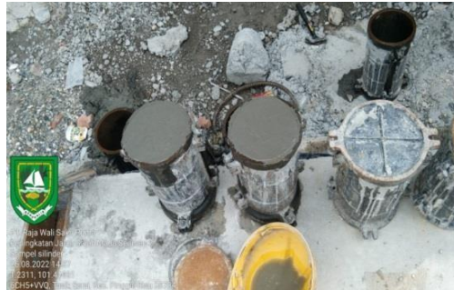
Gambar 3. 15 Pembuatan sampel beton f'c 30 mpa Sumber : Dokumentasi lapangan, 2023
