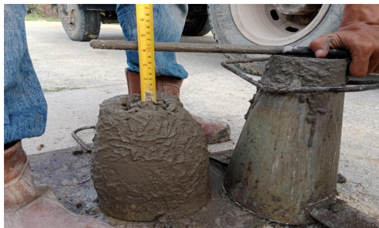
Gambar 3.5 Slump Test f_c 10 MPA Sumber : Dokumentasi lapangan,
