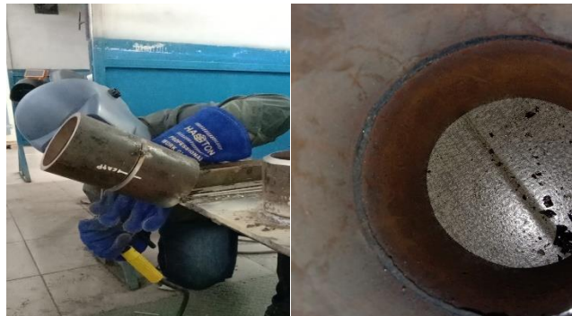
Gambar 4.38 Root penetrasi Sumber: Penulis
