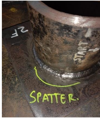
Gambar 4.63 Hasil inspeksi visual 2F Tee joint Sumber: Penulis
