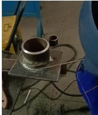
Gambar 4.49 penggerindaan sebelum menyambung lasan
