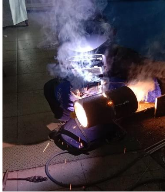
Gambar 4.43 Proses pengelasan 5G Sumber: Penulis
