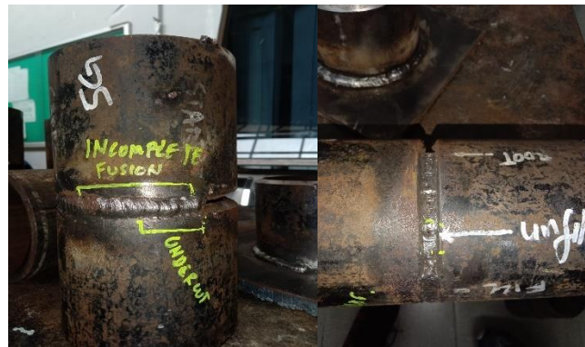
Gambar 4.60 Hasil inspeksi visual 5G Butt joint Sumber: Penulis
