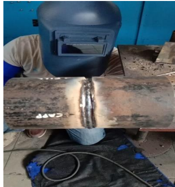
Gambar 4.41 Proses pengelasan 1G Sumber: Penulis
