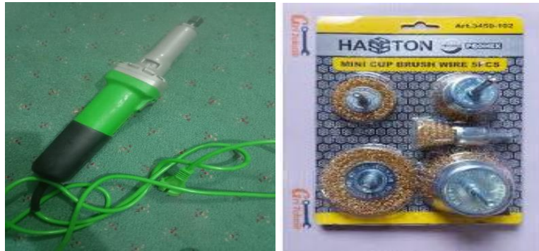
Gambar 4.8 Gerinda botol pembersih lasan/material Sumber: Penulis
