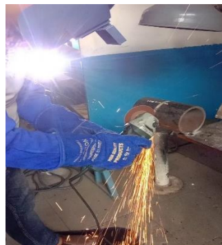
Gambar 4.39 Penggerindaan sebelum menyambung lasan Sumber: Penulis
