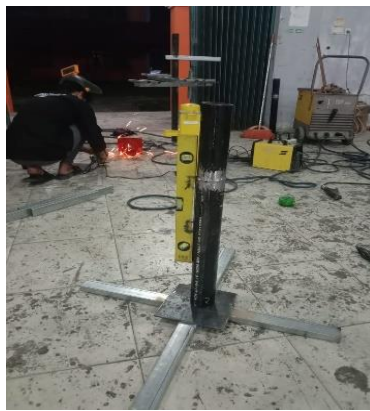
Gambar 4.79 Pembuatan tiang meja putar
