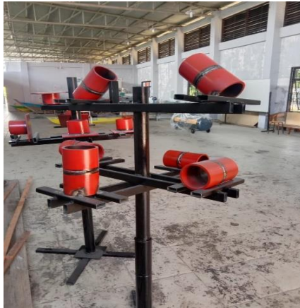
Gambar 4.81 Pemasangan pipa sample hasil pada meja pajang Sumber: Penulis
