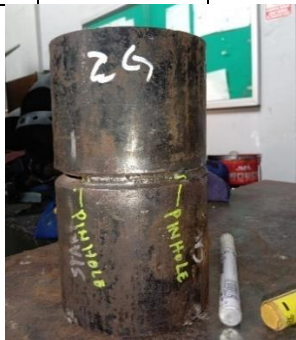
Gambar 4.59 Hasil inspeksi visual 2G Butt joint Sumber: Penulis
