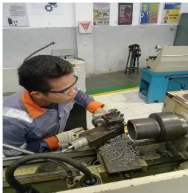
Gambar 4.28 pembuatan sudut bevel pipa melalui proses bubut Sumber: Penulis
