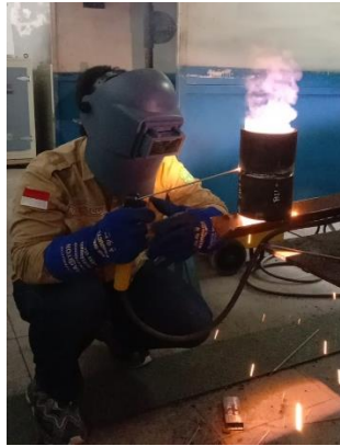
Gambar 4.42 Proses pengelasan 2G Sumber: Penulis
