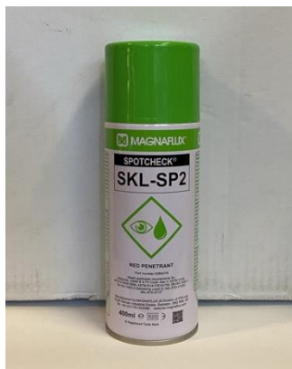
Gambar 4.66 Cairan red penetrant Magnaflux Sumber: Penulis
