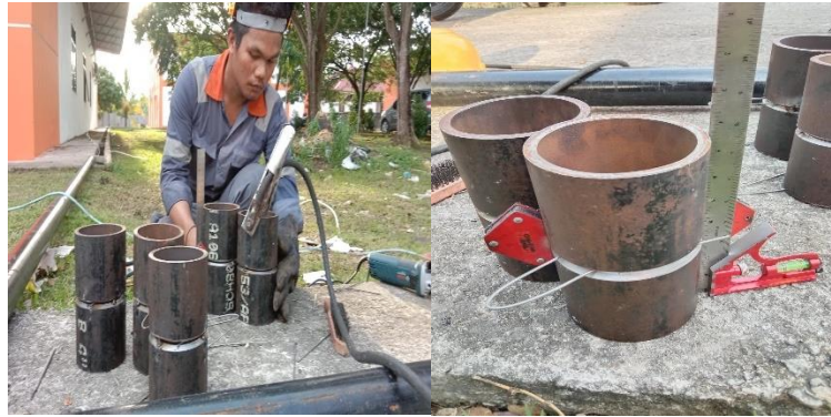
Gambar 4.36 Penanandaan struktur lapisan las
