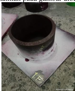
Gambar 4.72 Cacat undercut posisi 1F Sumber: Penulis
