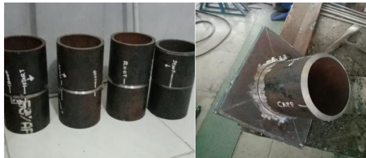
Gambar 4.35 Penanandaan struktur lapisan las Sumber: Penulis
