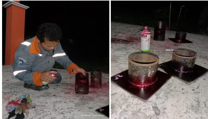
Gambar 4.67 Pengaplikasian cairan red penetrant Magnaflux
