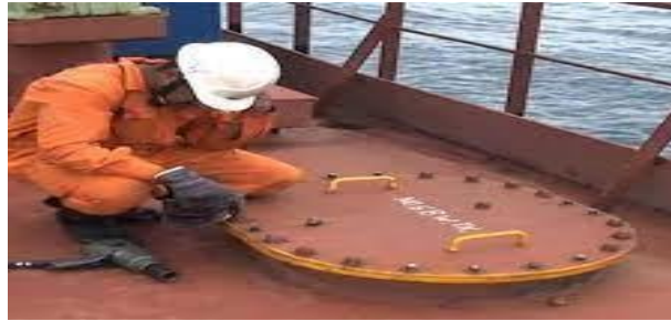
Gambar 3.1 Manhole pada kapal MT.Venus
