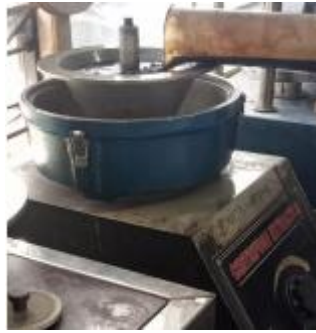
gambar 3. 9 Proses memasukkan bensin kedalam centrifuge ekstraktor berisi campuran aspal
