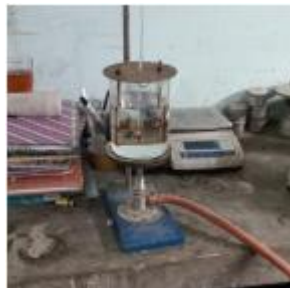
gambar 3. 6 Proses pengujian titik lembek aspal
