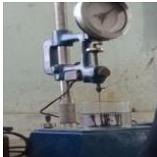
gambar 3. 3 Pengujian penetrasi aspal pen 60/70
