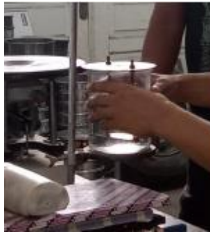
gambar 3. 5 Proses pengujian titik lembek aspal
