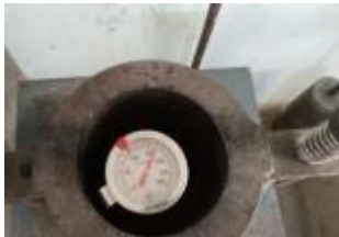
gambar 3. 19 Pengecekan suhu campuran aspal sebelum di padatkan
