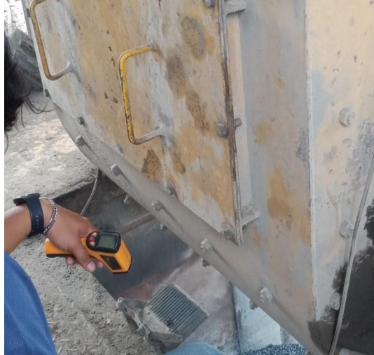
gambar 4. 3 Pengecekan suhu campuran aspal sebelum di mobilisasi
