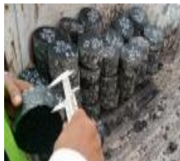
gambar 3. 28 Pengukuran tebal lapisan AC-WC
