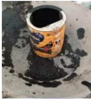
gambar 3. 2 Pemanasan aspal sebelum diuji
