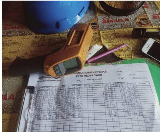
Gambar 2. 33 Kegiatan monitoring KWH setiap jamnya (Sumber: PT. Megapower Makmur Tbk. 2022)
