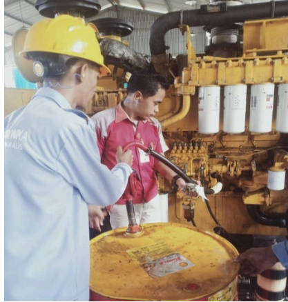
Gambar 2. 29 Kegiatan penambahan oli pada unit delapan
