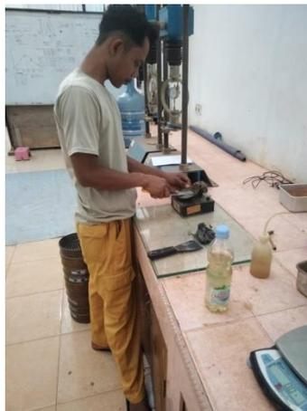
**Gambar3. 27** Pengujian Batas Cair
