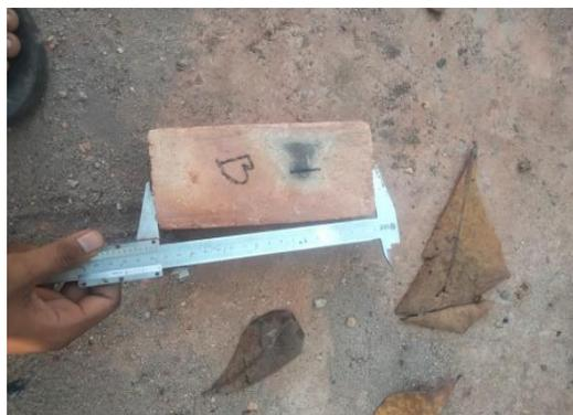
**Gambar3. 42** Pengujian Ukuran Batu Bata
