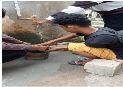
**Gambar3. 26** Pengujian Analisa Saringan
