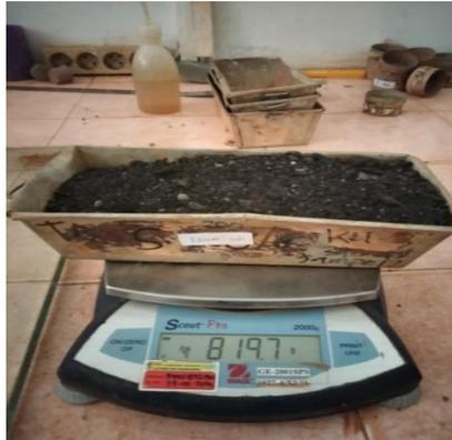
**Gambar3. 32** Pengujian Kadar Air
