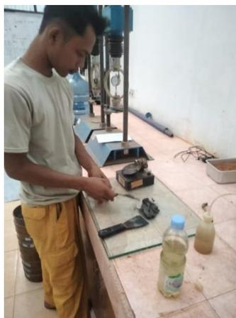
**Gambar3. 28** Pengujian Batas Plastis
