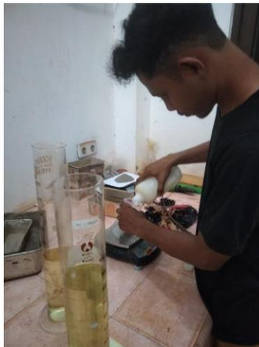
**Gambar3. 29** Pengujian Hidrometer
