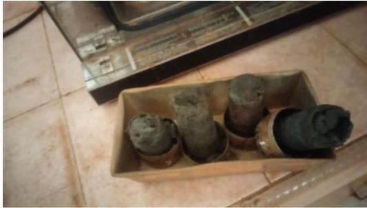
**Gambar3. 25** Pengujian Kadar Air Dan Berat Volume
