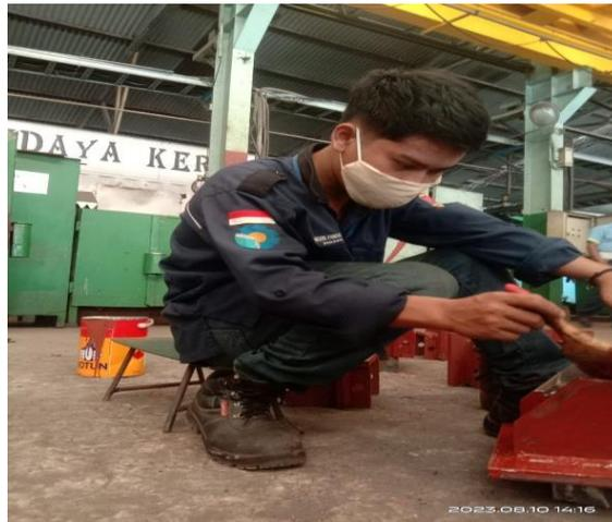
Gambar 3.6 pengecatan pada *Blowing Wall*
