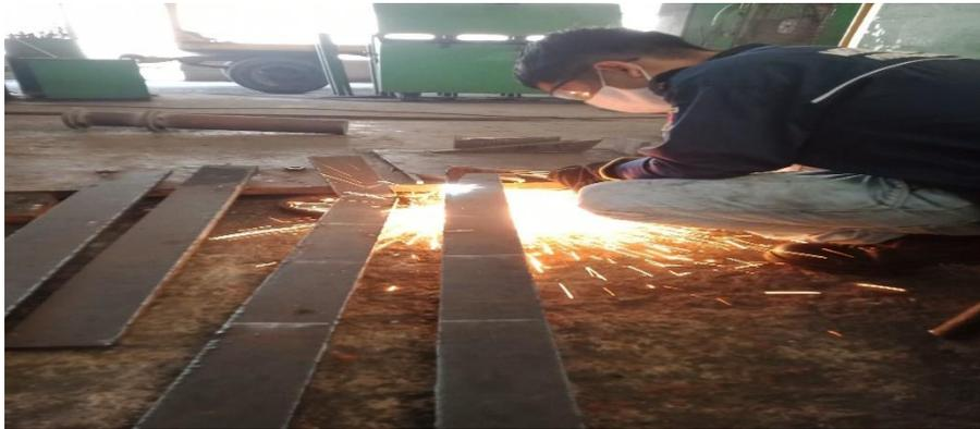
Gambar 3.25 Pemotongan plat pada *Blowing Wall*
