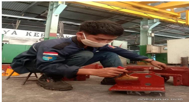
Gambar 3.3 pengecatan pada *Blowing Wall*
