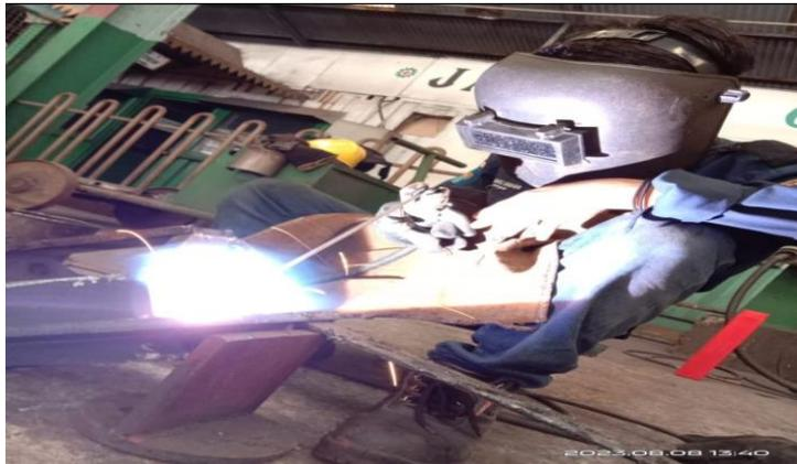
Gambar 3.26 Pengelasan pada *Blowing Wall*
