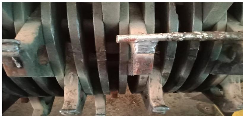
Gambar 3.14 penambahan Daging pengelasan pada *Rotor Crasher*
