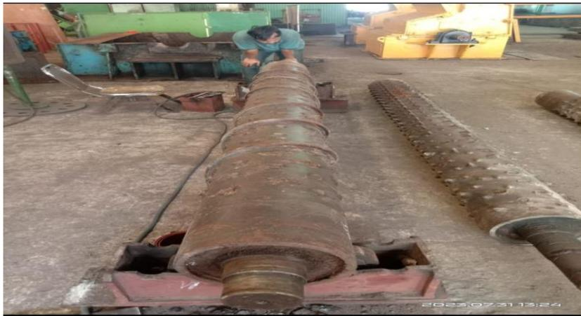
Gambar 4.6. Pengukuran sebelum memotong *drill*
