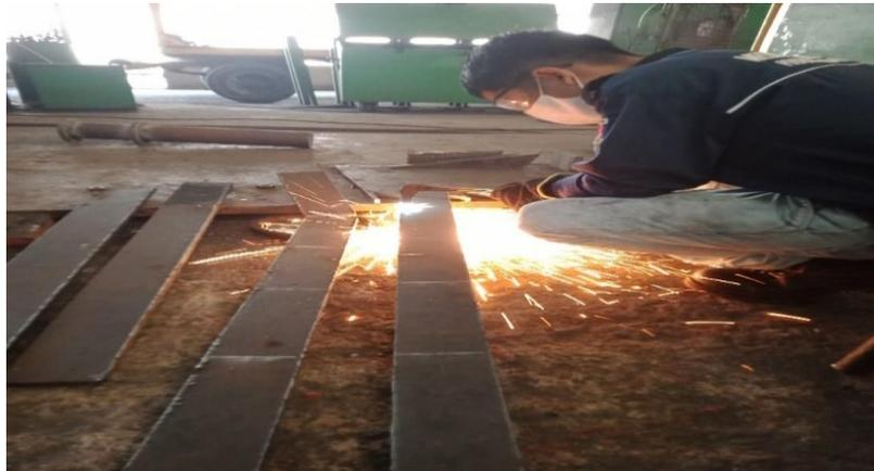
Gambar 3.18 pemotongan *Plat pada Blowing Wall*
