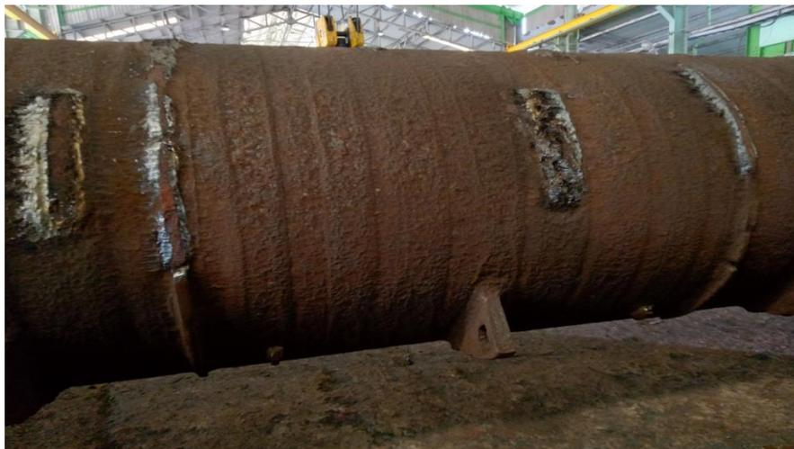
Gambar 3.20 Perbaikan pada *punchking*
