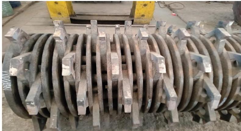
Gambar 3.17 penambahan Daging pengelasan pada *Rotor Crasher*
