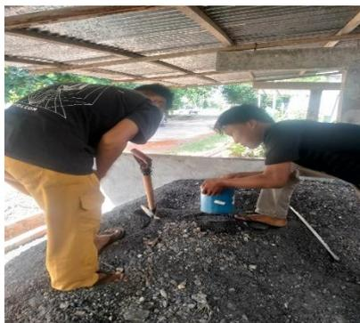
**Gambar 3.29** Pengujian Berat Volume Bottom Ash
