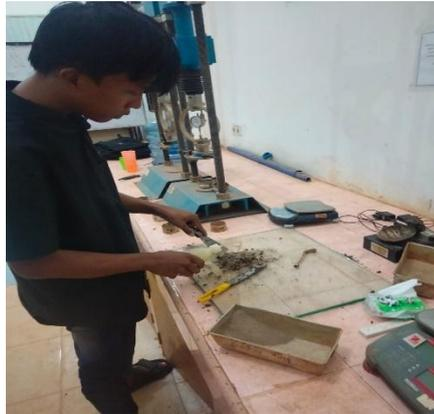
**Gambar 3.26** Pengujian *atterberg limit*
