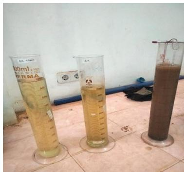
**Gambar 3.27** Pengujian *hydrometer*
