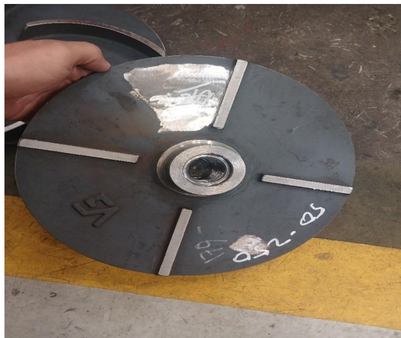
Gambar 4. 14 Benda kerja yang telah balance (Sumber: dokumen pribadi)
