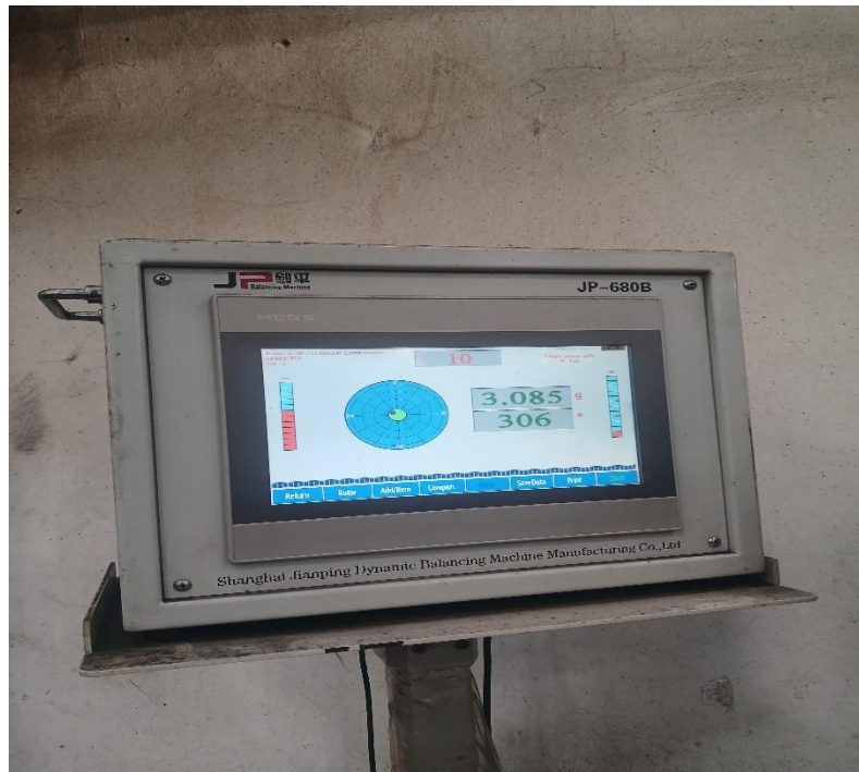
Gambar 4. 13 Benda kerja yang telah balance pada saat pengecekan (Sumber: dokumen pribadi)
