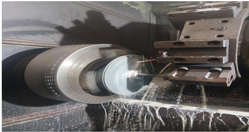
Gambar 4. 7 Proses pembubutan dalam (Sumber: dokumen pribadi)
