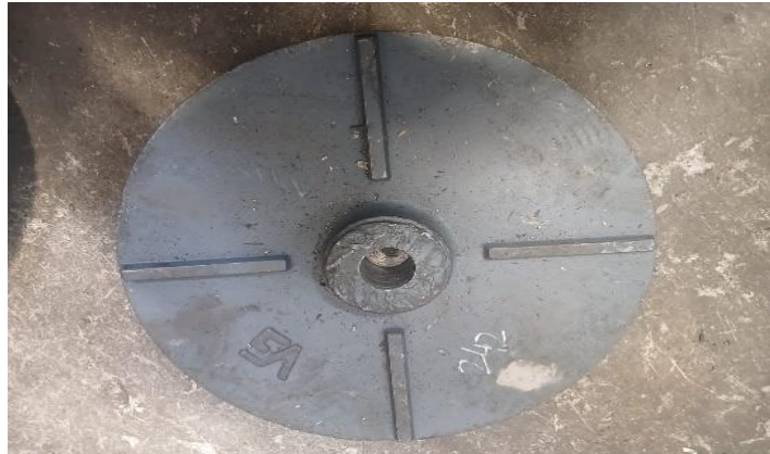
Gambar 4. 3 Benda kerja yang telah dilakukan center (sumber: dokumen pribadi)
