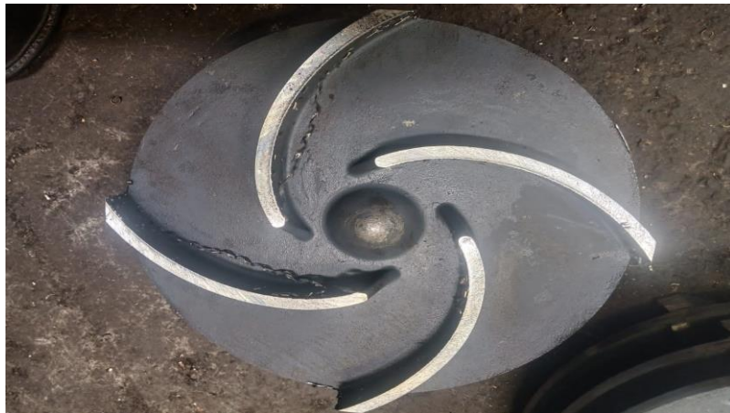
Gambar 4. 6 Benda kerja yang telah selesai pemakanan 80% (Sumber: dokumen pribadi)
