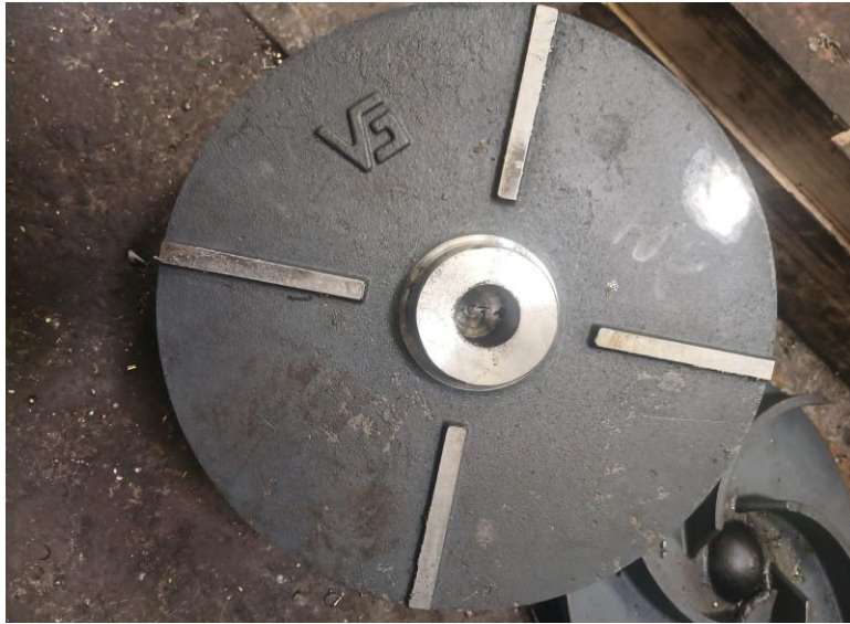
Gambar 4. 5 Benda kerja yang telah selesai pemakanan 40% (Sumber: dokumen pribadi)
