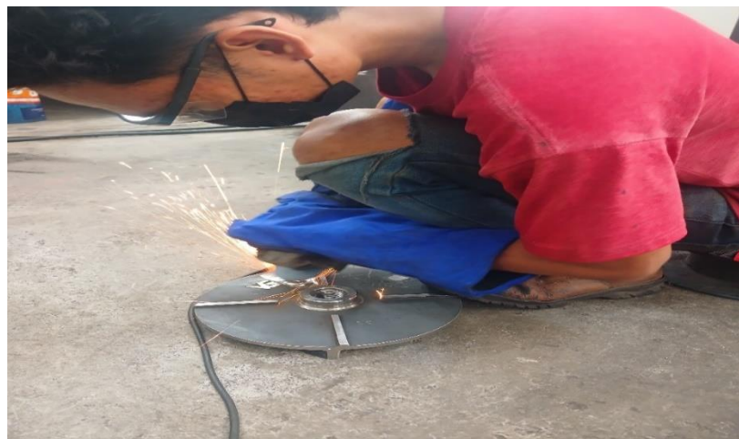
Gambar 4. 12 Proses grinding pada impeller (sumber: dokumen pribadi)
