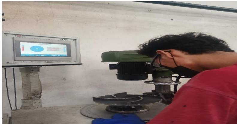
Gambar 4. 11 Proses pengecekan dan penandaan pada benda kerja yang tidak balance (Sumber: dokumen pribadi)
