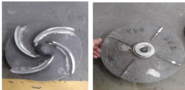
Gambar 4. 10 Benda kerja yang telah di finishing (Sumber: dokumen pribadi)
