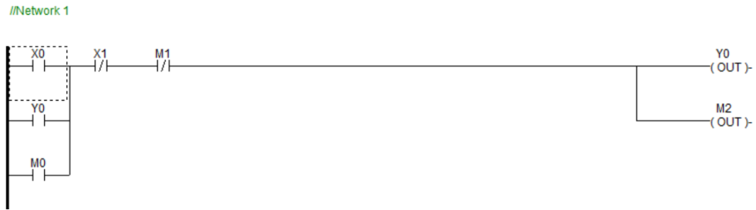
Gambar 3.12 Rancangan Software PLC Praktikum 1 Sumber: (Dokumentasi, 2024)
