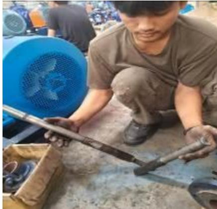
**Gambar 4. 25 Patah bagian *shaft***
