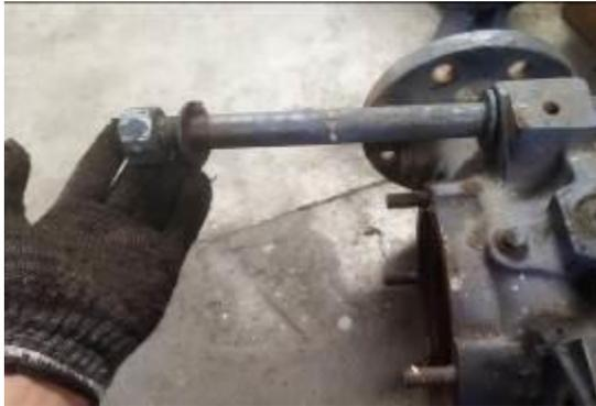
**Gambar 4. 20 pelepasan 4 Rod pada pompa**
