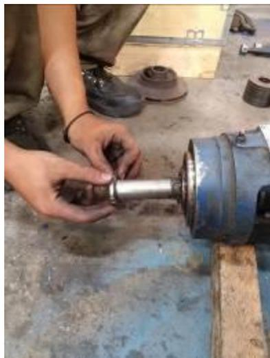
**Gambar 4. 17 Melepaskan nut dan lock washer**
