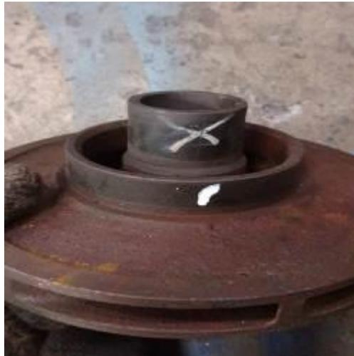
**Gambar 4. 26 Crack Pada *Impler***
