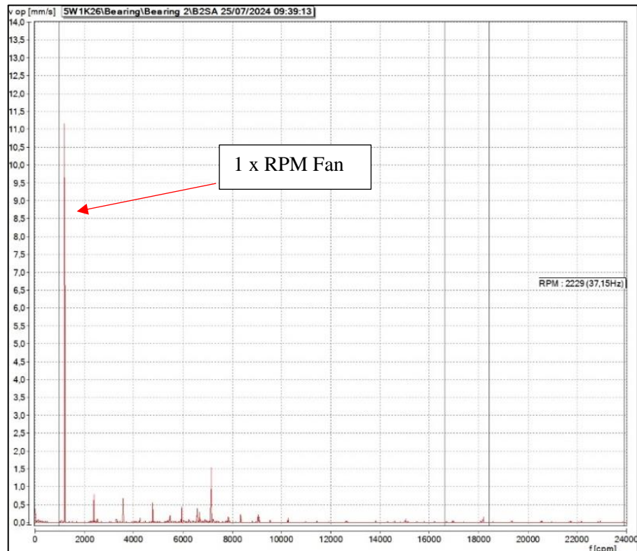
Gambar 4. 28 Data Spectrum Sebelum balance ( Sumber : PT. Semen Padang)
