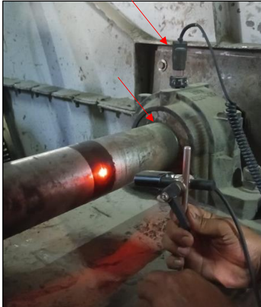
Gambar 4. 32 peletakan sensor di depan poros ( Sumber : Dokumen pribadi)
