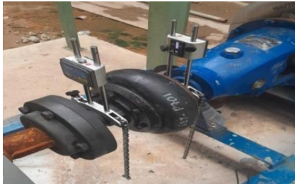
Gambar 4. 4 Metode Alignment Laser (Sumber : Dokumentasi Pribadi)
