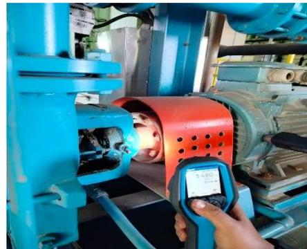
Pengecekan kondisi kopling saat kopling berputar menggunakan alat SKF Stroboscope TKRS 31
