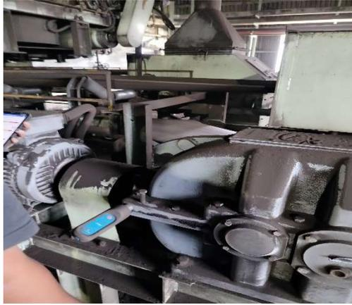
Pengecekan Vibrasi pada *conveyor*.
