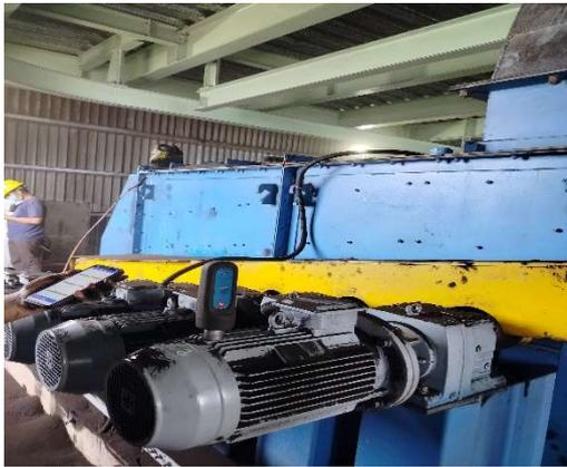
Pengecekan Vibrasi pada *coal screen*
