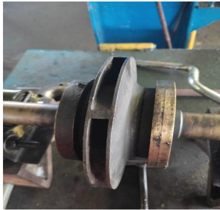
Gambar 4.6 kerusakan crack pada impeller (sumber Dokumentasi Pribadi )
