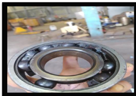
Gambar 4.8 Bearing Terjadi Korosi Dan Pecah ( Sumber Dokumentasi Pribadi )
