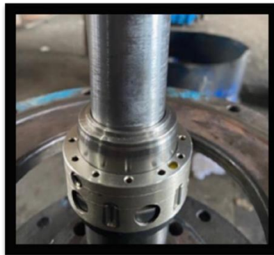
Gambar 4.11 Mechanical Seal ( Sumber Dokumentasi Pribadi )
