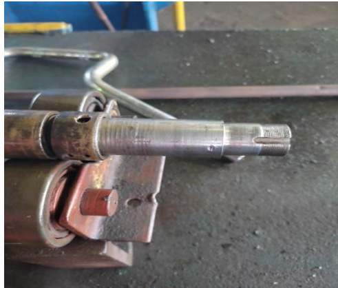
Gambar 4.7 Shaft Mengalami Korosi Dan Pecah ( Sumber Dokumentasi Pribadi )
