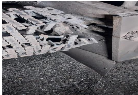
Gambar 4.4 Chaingrate Rusak Sumber: Dokumentasi Pribadi
