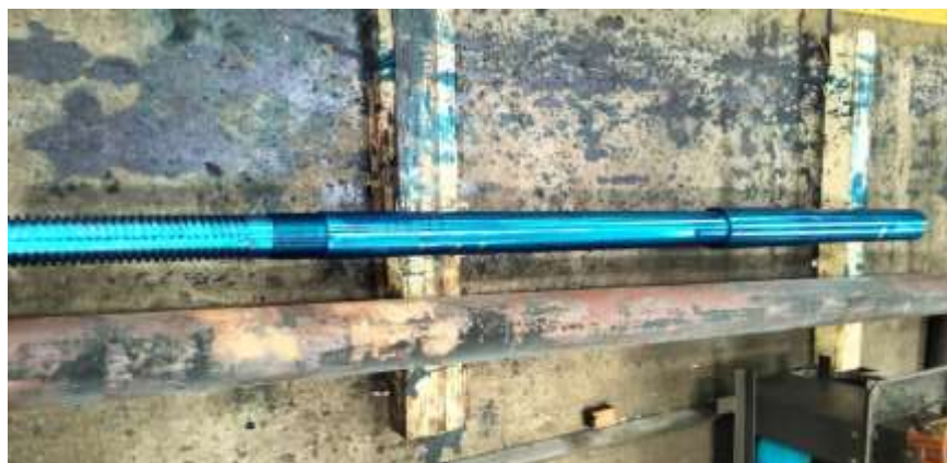
Gambar 4.18 Sudah Dicat Dan Dipasang Anak Spi (Sumber: dokumen pribadi)
