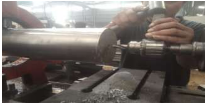
Gambar 4.6 Proses Peng-Boran (Sumber: dokumen pribadi)
