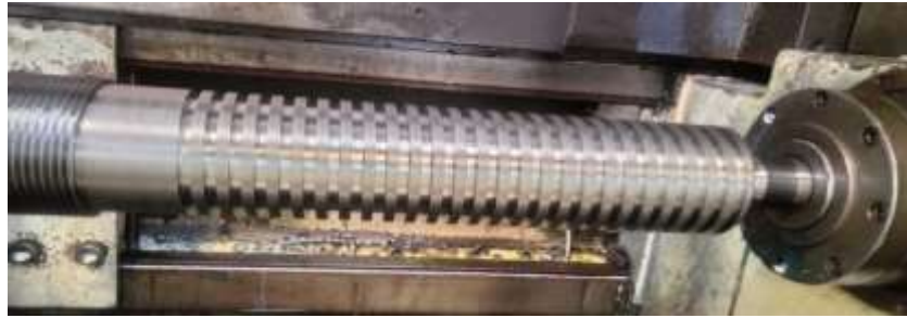
Gambar 4.15 Hasil Proses Pembuatan Drag 2G/1 Atau Ulir Kanan (Sumber: dokumen pribadi)
