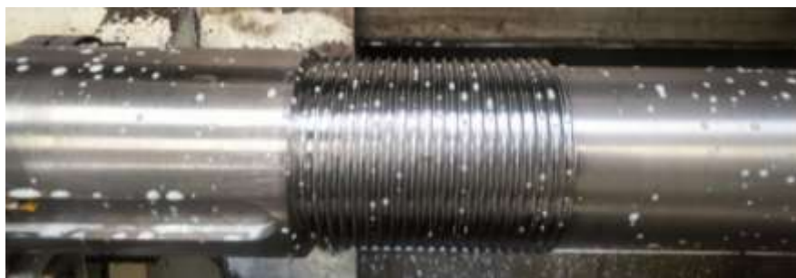
Gambar 4.14 Hasil Proses Pembuatan Drag 6G/1 Atau Ulir Kiri
