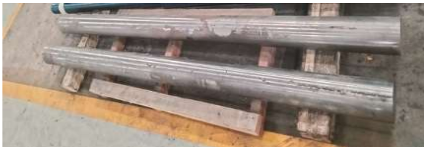
Gambar 4.3 Bahan Mentah Belum Jadi Main Shaft Ek 300k-Pn4
