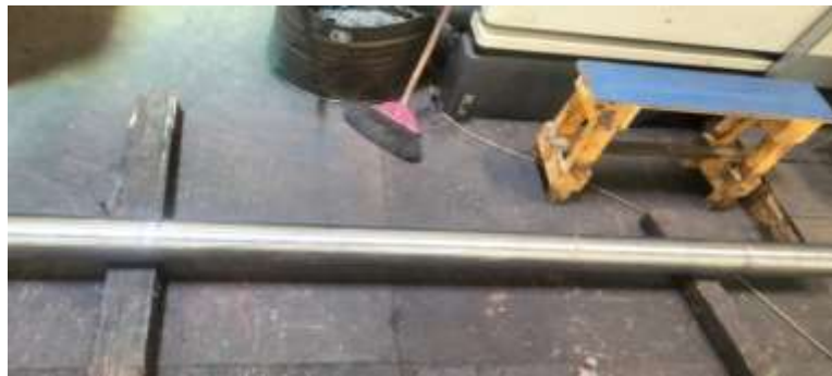
Gambar 4.12 Benda Kerja Yang Telah Selesai Pembubutan 100% (Sumber: dokumen pribadi)
