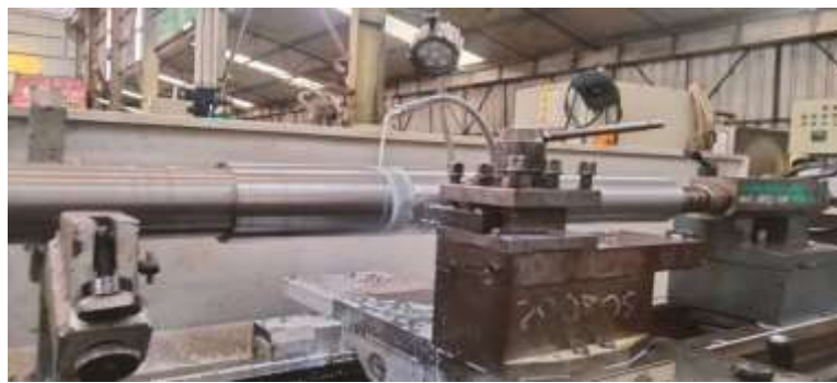
Gambar 4.11 Proses Pemakanan Bagian Belakang Main Shaft Ek 300k-Pn4 75% (Sumber: dokumen pribadi)
