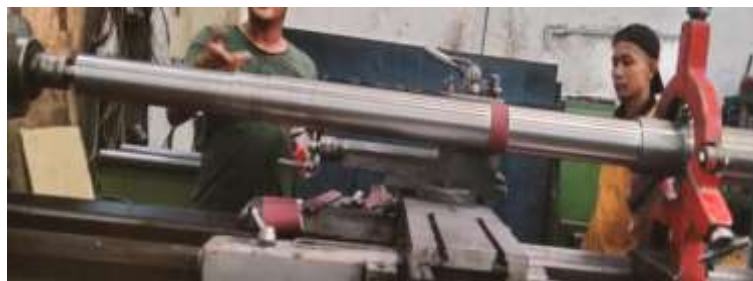
Gambar 4.10 Hasil Pemakanan Bagian Depan Benda Kerja 50% dan Langsung Di Finishing dan Di Amplas (Sumber: dokumen pribadi)
