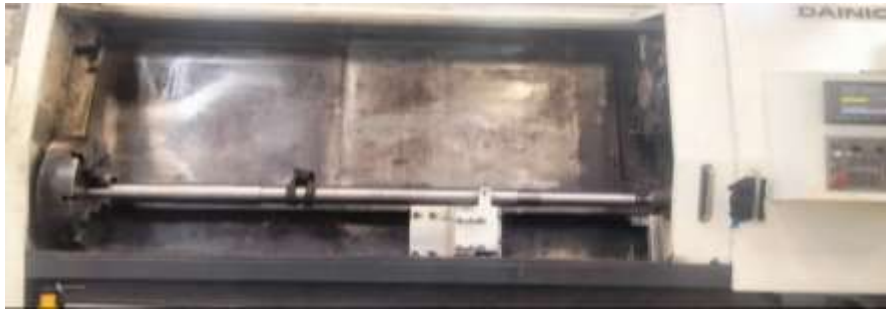
Gambar 4.13 Proses Pembuatan Drag/Ulir
