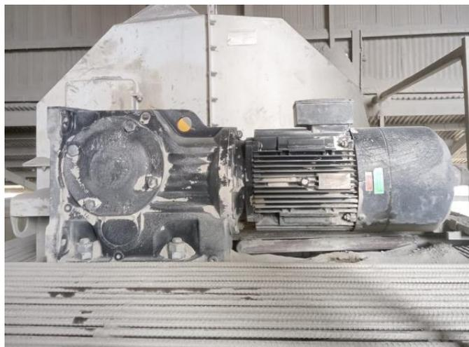
**Gambar 4. 6** Motor dan *Gearbox*
