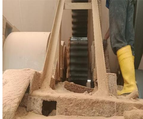
**Gambar 5.1. bagian granulator yang memiliki titik jumpa**
