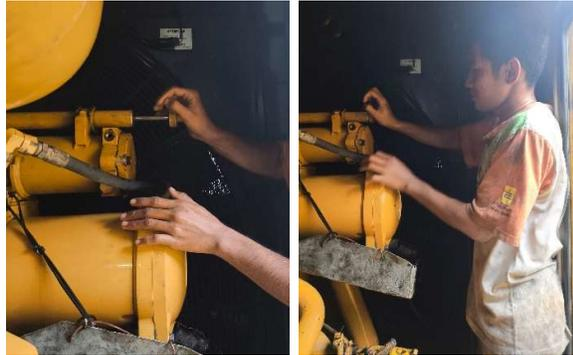
Gambar 4.31 Lakukan Pembuangan Udara
