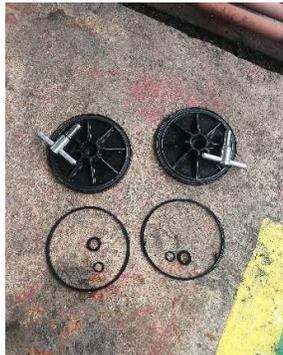
Gambar 4.21 Ganti Seal Penutup Filter Racor
