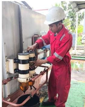
Gambar 4.24 Kunci Penutup Filter Racor
