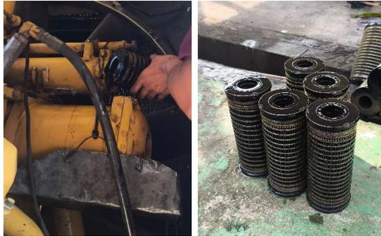
Gambar 4.28 Keluarkan Fuel Filter yang Kotor
