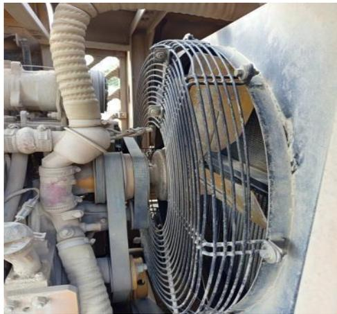
*Gambar 4.16 : mengganti seal pada as poli kipas radiator
