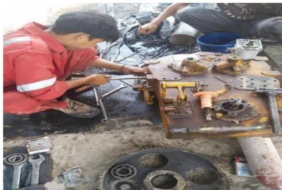
*Gambar 4.12 : mengganti seal transmisi
