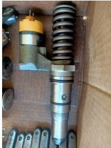
Gambar 4.4.8 Electronic Unit Injector Sumber: PT. PLN (Persero) PLTD II Bengkalis
