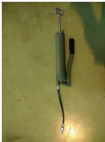
Gambar 3. 20 Grease pump (Sumber : Dokumentasi Pribadi)
