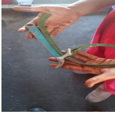
Gambar 3. 23 kunci filter (Sumber : Dokumentasi Pribadi)
