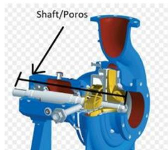
Gambar 4. 5 Shaft/poros pompasentrifugal
