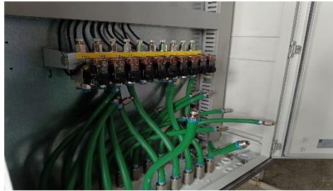
Gambar 2. 11 Mengganti SV merek luciver ke SMC
