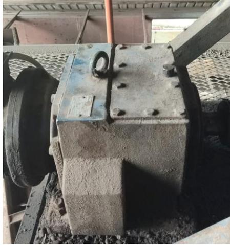
Gambar 4.7. Gearbox konveyor
