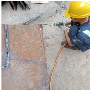
Gambar 3.3. Pemotongan pelat
