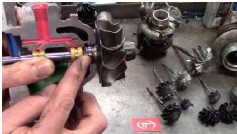
Gambar 3.6 Aktifitas Penggantian Bearing yang Aus
