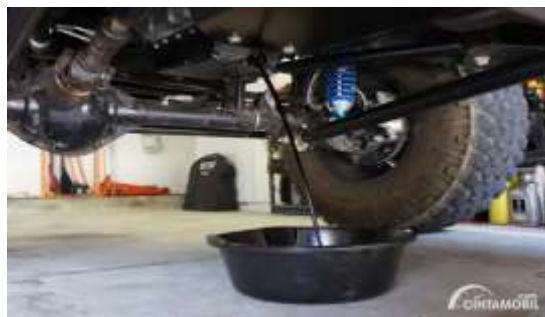
Gambar 3.4 Aktifitas Penggantian Oli Mesin Diesel Sumber : Dokumentasi
