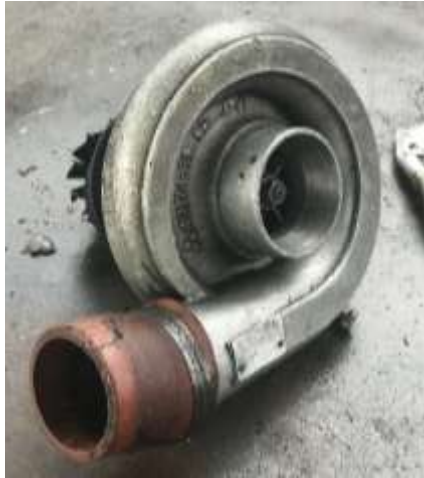
Gambar 3.2 Selesai Pembersihan Turbo Charger Sumber : Dokumentasi
