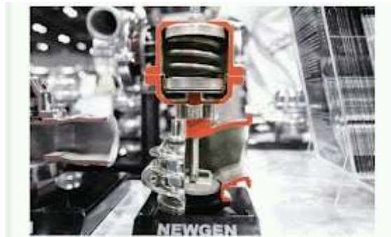
Gambar 4.11 Wastagates pada Turbo Charger Sumber : Dokumentasi
