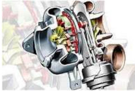
Gambar 4.27 Sistem Center Housing Sumber : Dokumentasi
