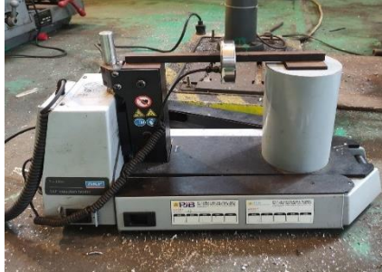
Gambar 3. 12 Bearing Heater Sumber: dokumentasi pribadi
