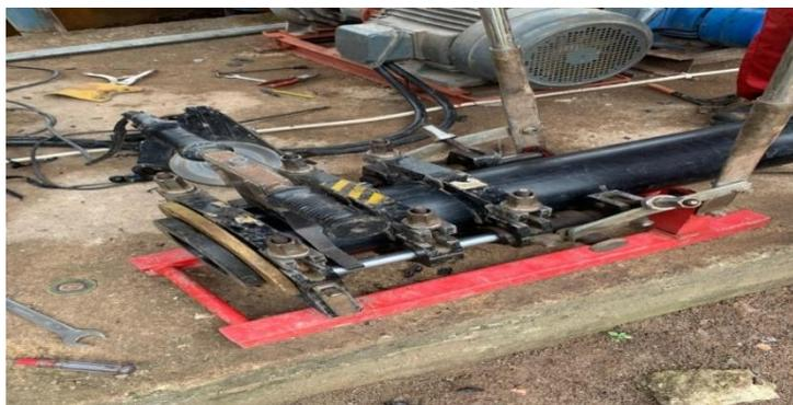
Gambar 3. 6 Alat Penyambung Pipa HDPE
