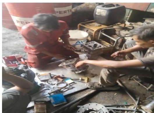
Gambar 4.14 : mengganti seal pada pompa hidrolig sumber : Dokumentasi sendiri
