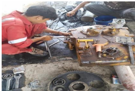
Gambar 4.12 : mengganti seal transmisi sumber : Dokumentasi sendiri
