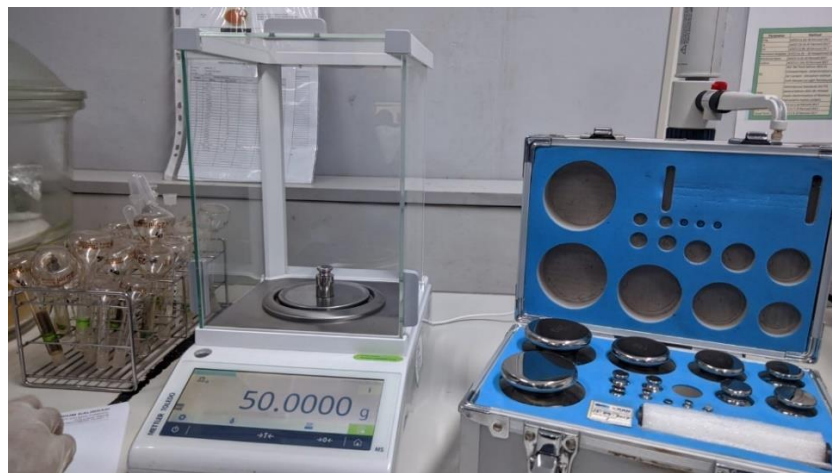
Gambar 2. 2 Uji antara anak timbang laboratorium Sumber: (Dokumentasi, 2024)
