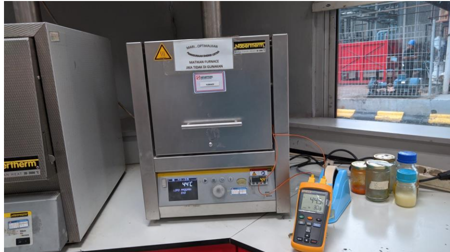
Gambar 2. 36 Calibration Furnace di Laboratirium uji. (Sumber: Dokumentasi, 2024)
