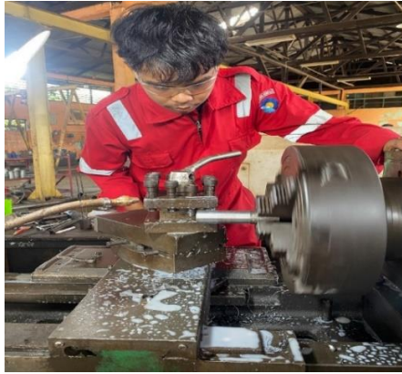
Gambar 4. 4 Proses faching(bubut muka)
