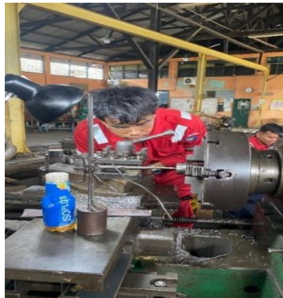
Gambar 4. 24 Proses pembubutan ulir dalam
