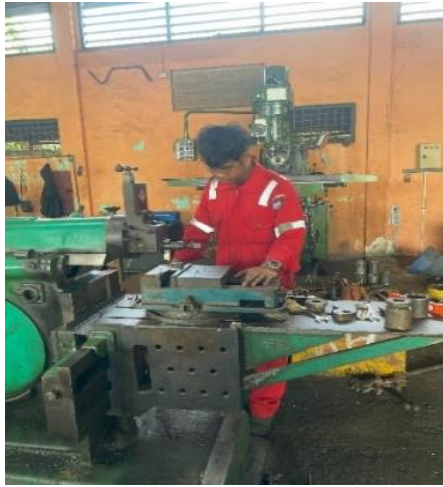
Gambar 4. 25 Proses pembuatan segi dua dengan mesin scrap
