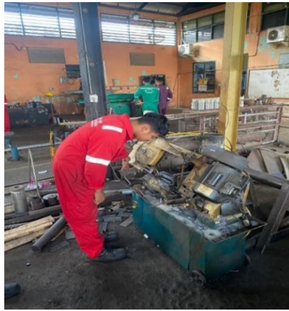
Gambar 4. 2 Pemotogan Benda Kerja
