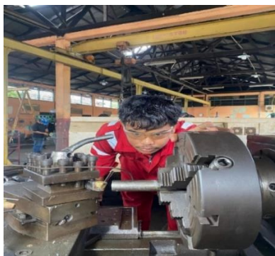
Gambar 4. 3 Proses mendiel benda kerja
