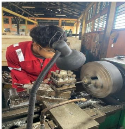
Gambar 4. 20 Proses pembubutan dalam
