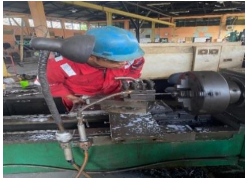
Gambar 4. 12 Pembubutan rata dalam
