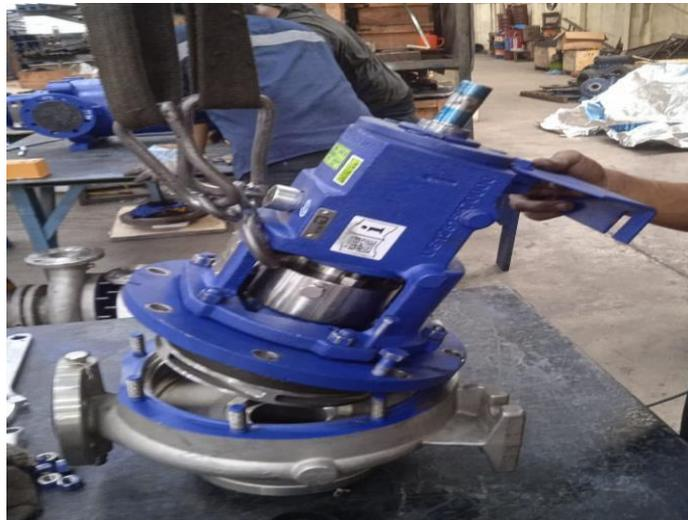
Gambar 4. 20 Pemasangan casing dengan bearing housing
