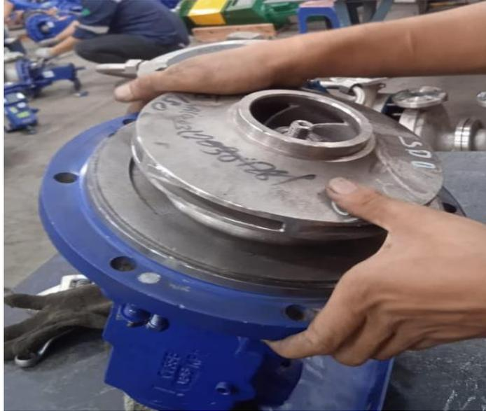
Gambar 4. 19 Pemasangan impeller
