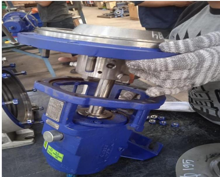
Gambar 4. 17 Pemasangan seal plate pada bearing housing
