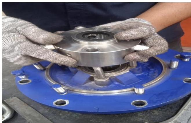
Gambar 4. 16 Pemasangan seal plate pada clan housing
