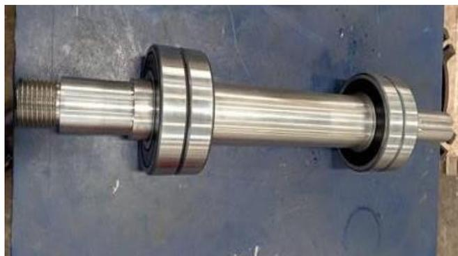
Gambar 4. 13 Pemasangan bearing pada shaft
