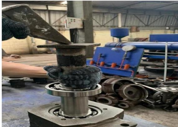
Gambar 4. 14 pemasangan Drive shaft pada Bearing Housing
