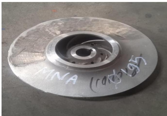
Gambar 4. 5 Impeller
