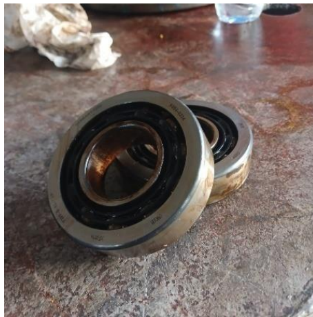
Gambar 4. 10 Bearing yang mengalami kerusakan
