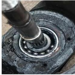
Gambar 4. 14 bearing (6306) yang sudah mengalami kerusakan
