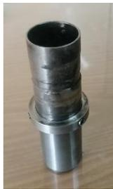
Gambar 4. 15 sahf sleeve sudah mengalami keausan hingga
