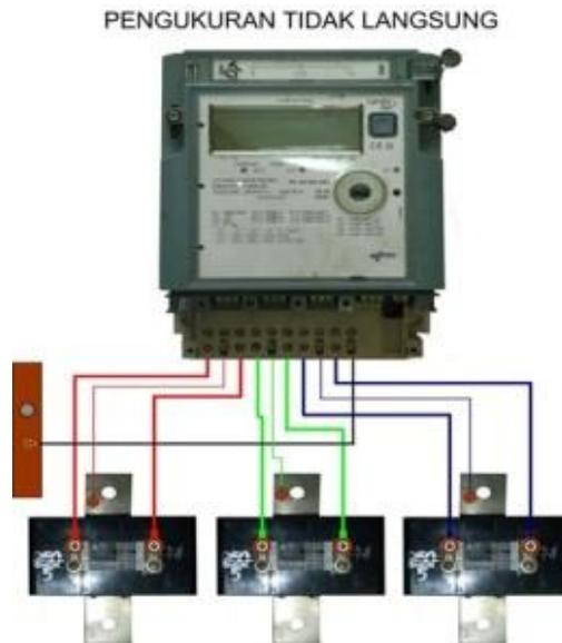
Gambar 2. 47 Pengawatan APP 3 Fasa Pengukuran Tidak Langsung
